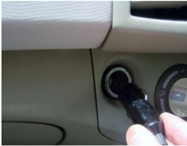
(7)コンプレッサーの電源プラグを自動車の電源ソケットに差し込みます
