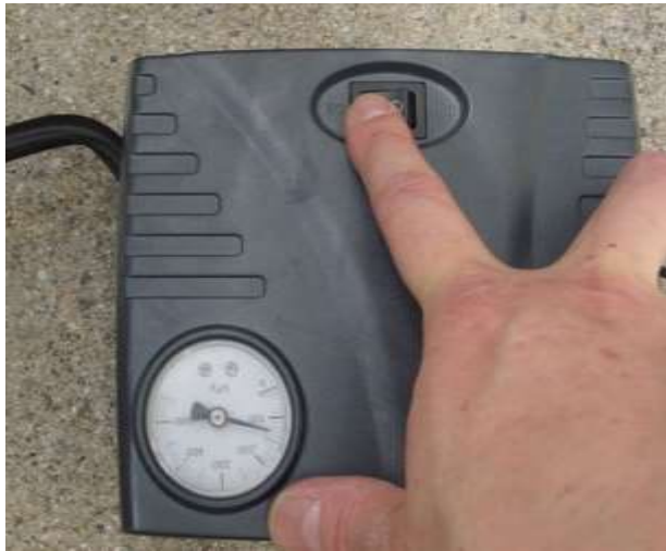
(8)コンプレッサーのスイッチを入れコンプレッサーを稼働させます。
