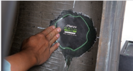
14 パッチ裏面の保護フィルムを剥がし、パッチの中心にキズ穴を合わせ貼りつけます。※保護フィルムを剥がす際にパッチの緑色の部分(接着層)を手で触れないように注意してください。
