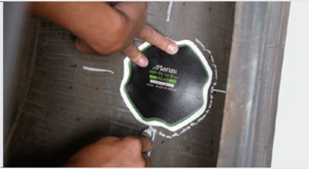
9 タイヤパッチMBの中心がキズ穴にくるようにセットし、パッチより少し大きめにクレヨンなどで線取ります。
