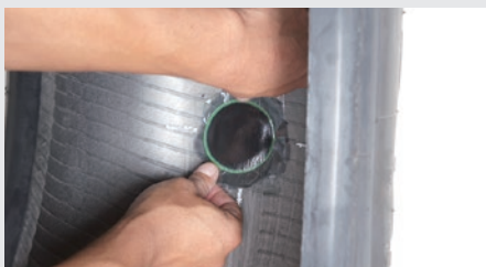
14 パッチ裏面のアルミ箔を剥がし、パッチの中心にキズ穴を合わせ貼りつけます。※アルミ箔を剥がす際にパッチの緑色の部分(接着層)を手で触れないように注意してください。
