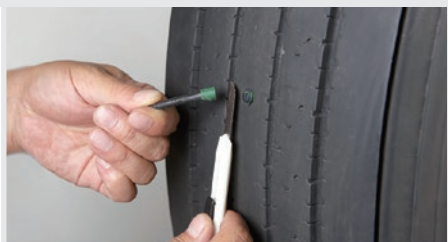
16 タイヤ外側に出ているステムを2~3mm程度残り切り取り、タイヤ内側のオーバーバフ部をシーライナーで補修します。これで作業は終了です。
