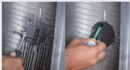
10~13 内面修理手順 タイヤパッチMR&マルニシステム(23ページ)と同じように進めます。
