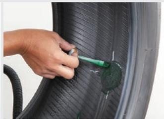
**10** バフ掛けした面にスーパーバルカンGを薄く均等に塗り、十分に乾燥させます。
