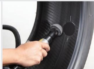
**7** タングステンスプをエアーツールにセットし、縁取った内側をバフ掛けします。※削りすぎないように十分注意してください。パッチが接着しない原因となります。
