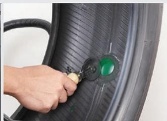
**14** パッチ部をローラーなどで圧着します。※パッチ中央部から外側に向け空気を抜くイメージで圧着してください。
