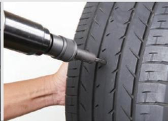
**2** タイヤ外面からカーバイトカッターをセットしたエアーツールでキズ穴を調整します。※この作業を2回繰り返します。
