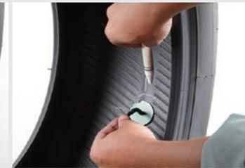
**4** プラグパッチのパッチ部の中心がキズ穴にくるようにセットし、パッチより少し大きめにクレヨンで縁取ります。
