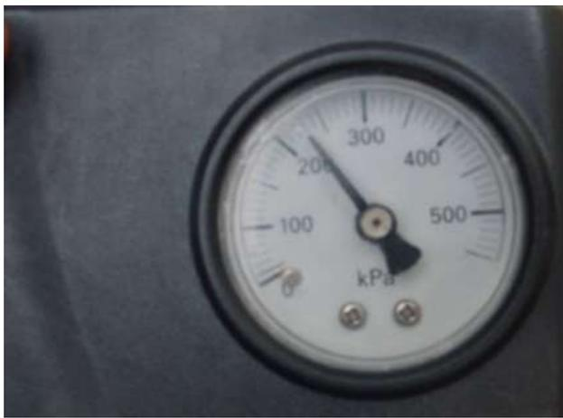
(9)指定空気圧まで空気を充填します。
