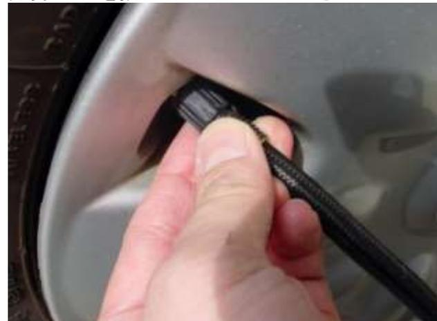
(6) コンプレッサーのノズルをバルブ部に接続します。
