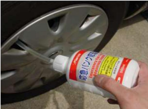
(4) キャップを外し、注入ノズルを取付けます。
